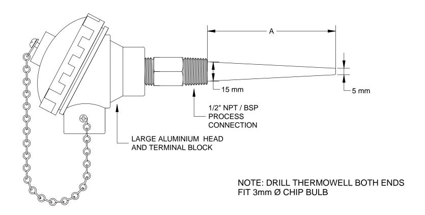
**CLASS A** RTD PT100 SENSOR LARGE ALUMINIUM HEAD SPECIAL MACHINED TAPERED STEM
